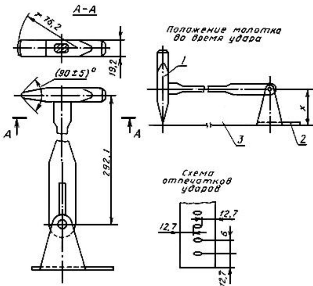
1 - молот; 2 - прижимная плита; 3 - поверхность образца;  $x$  - размер, определяемый опытным путем в зависимости от металла, из которого изготовлена головка молотка
